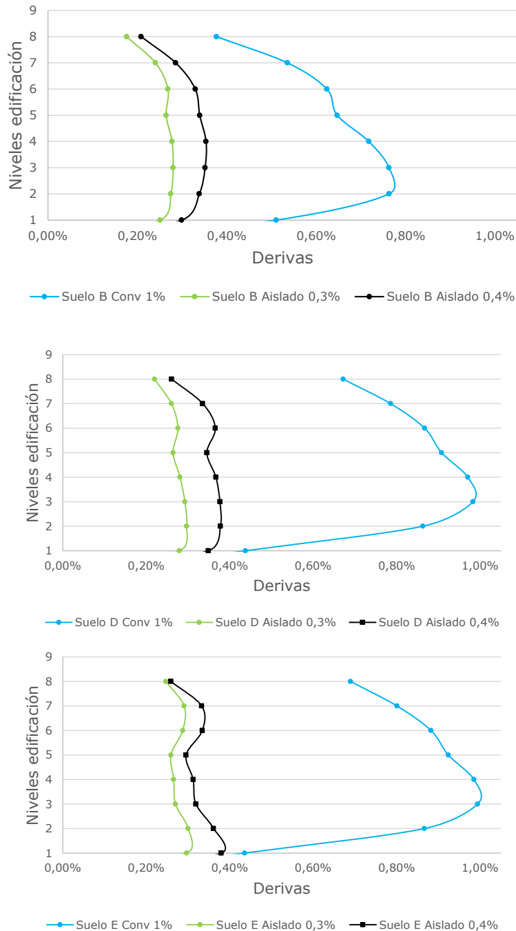
Figura 38: Derivas en cada nivel de las edificaciones analizadas. Dirección Y. Suelo firme (a), suelo intermedio (b) y suelo blando (c).
