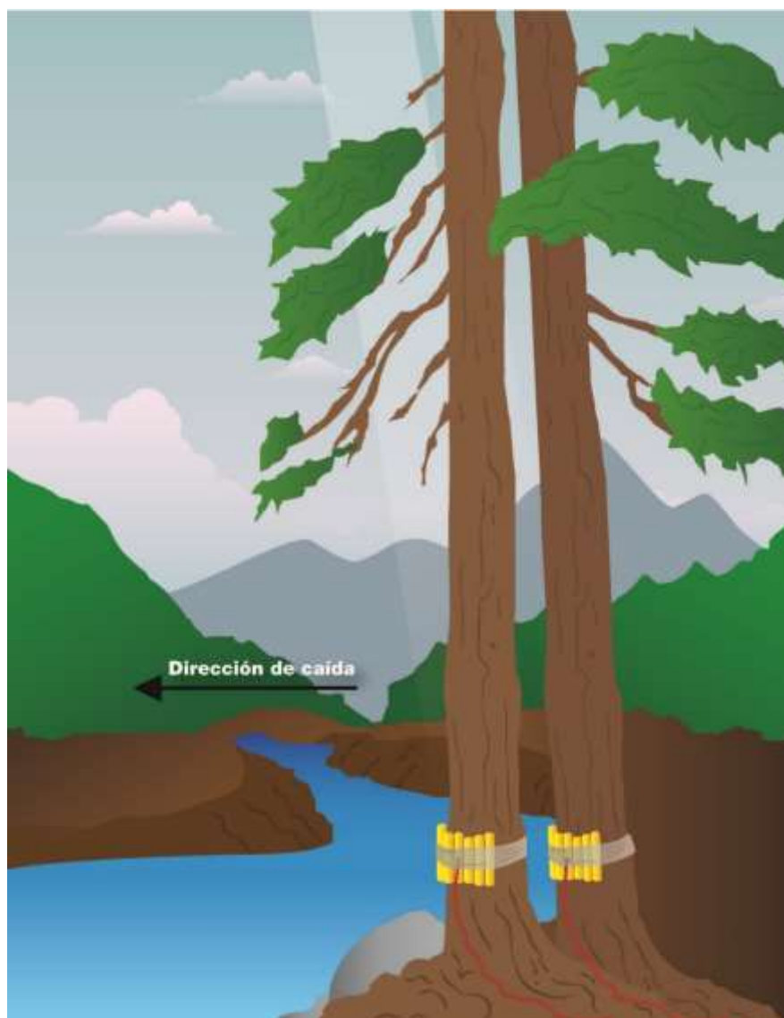
Figura 19: Entramado de corte de carga externa
