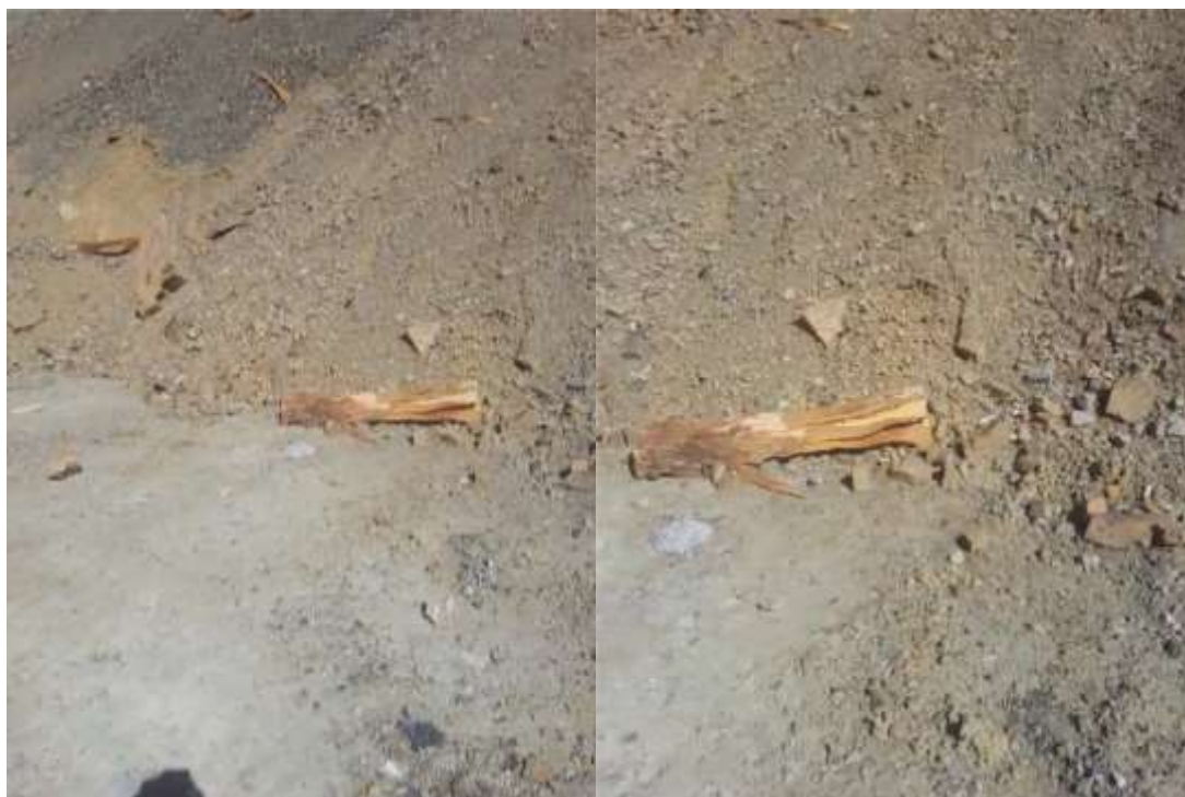
Figura 53: Fragmentos Resultantes Quinta Prueba con Carga Interna Fuente: Elaboración propia
