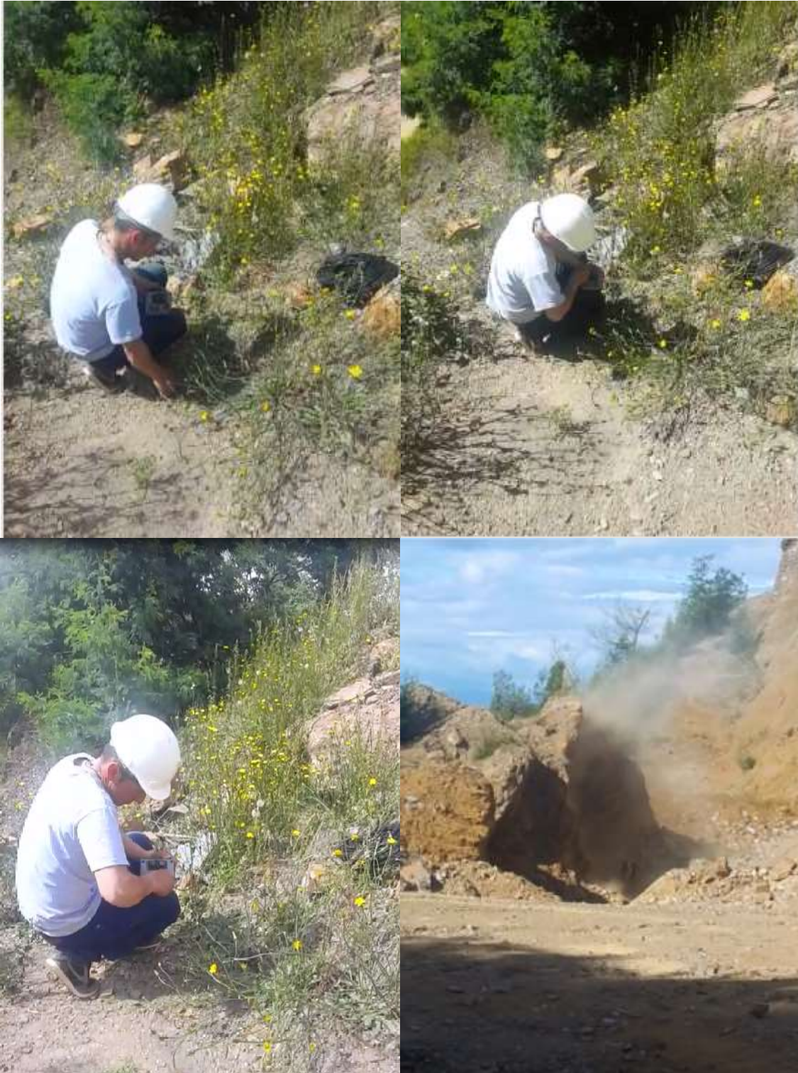
Figura 45: Voladura Carga Externa Fuente: Elaboración propia
