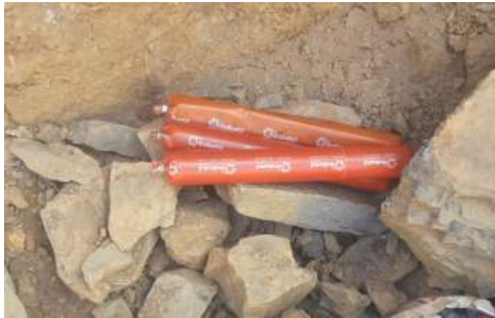
Figura 27: Muestra Explosivo Indugel Plus PM Fuente: Elaboración propia
