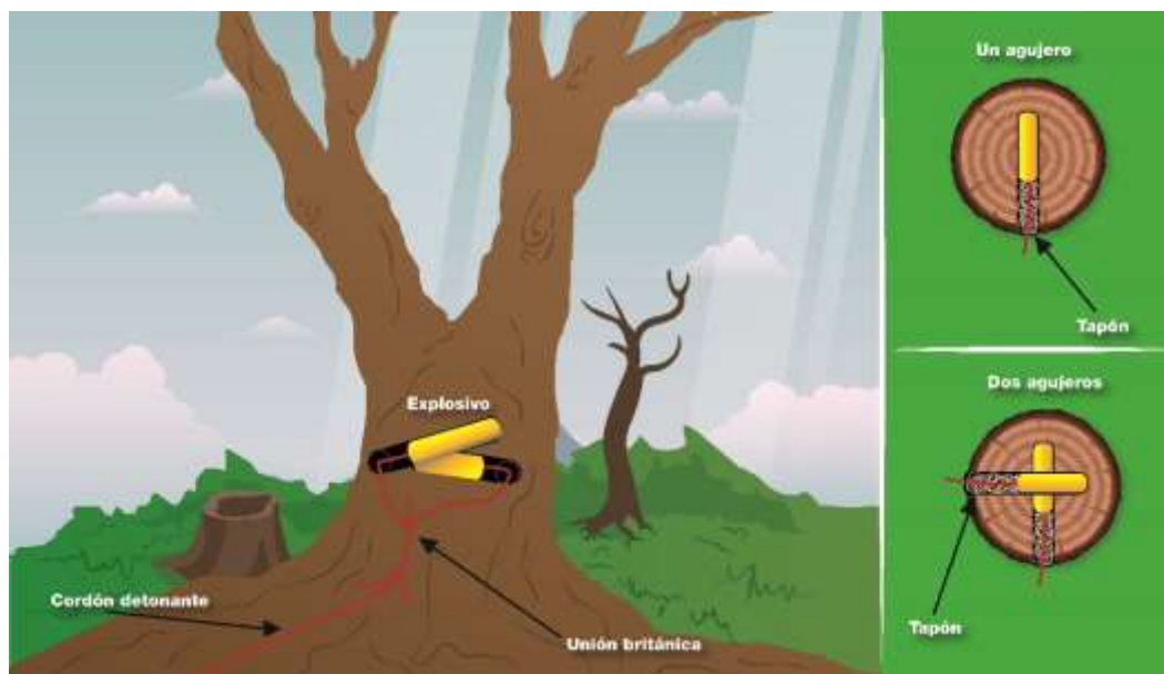
Figura 15: Entramado de corte de carga interna
