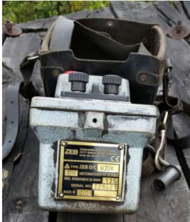
Figura 29: Muestra Explosor ZEB D/C Utilizado Fuente: Elaboración propia
