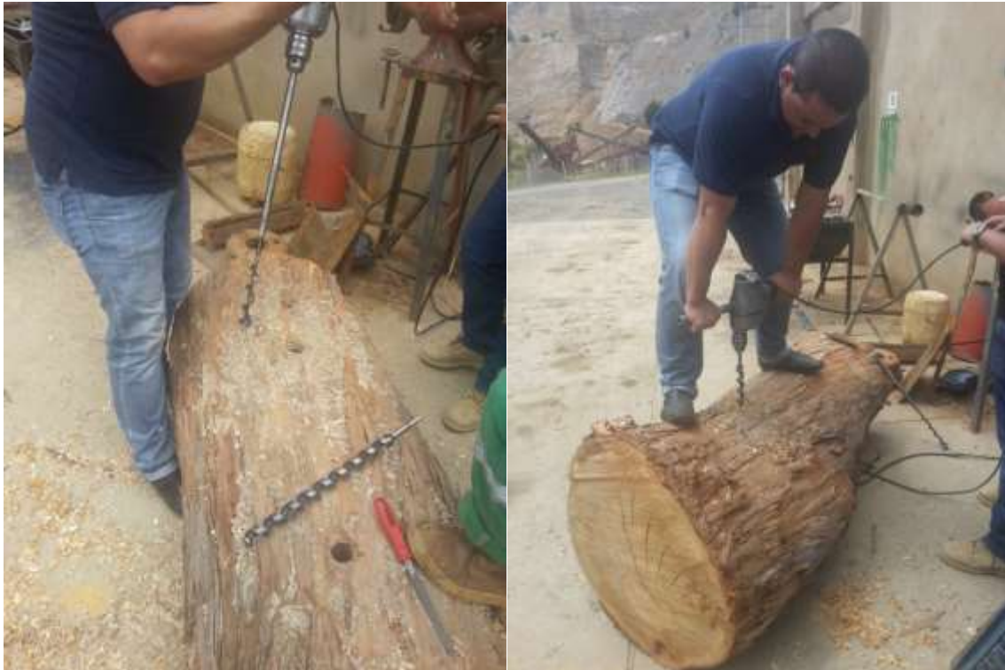
Figura 31: Elaboración de Barrenos para Carga Interna
