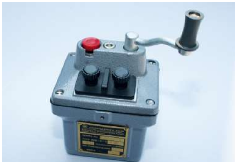
Figura 12: Explosor permissible ZEB D/C 30-U Fuente: www.zeb-maxam.com
