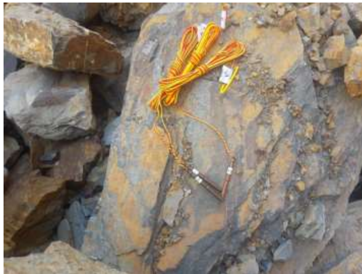
Figura 28: Muestra Detonador Permissible Eléctrico Insensible de Cobre Fuente: Elaboración propia
