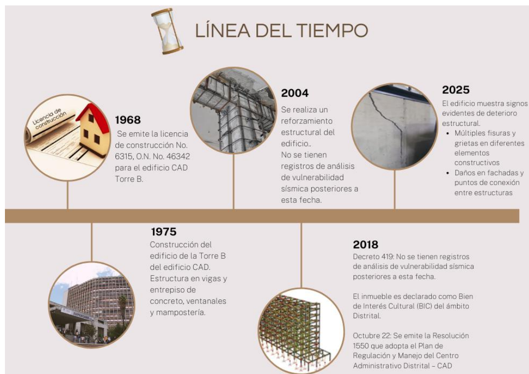
Ilustración 2 línea del tiempo análisis estructural edificio administrativo
