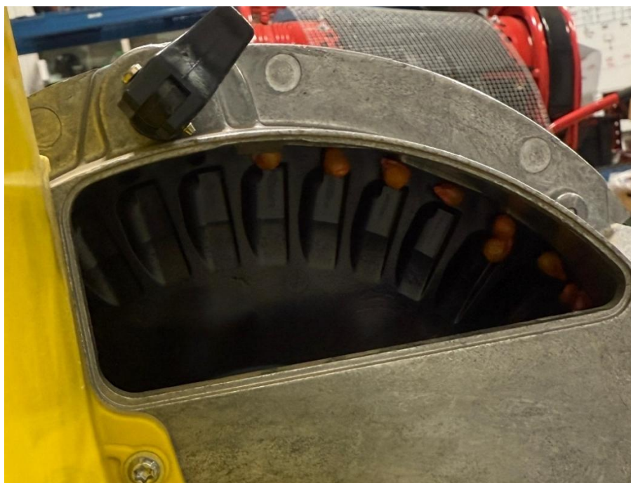
Imagen 38 – Detección Semillas Múltiples de Maíz
