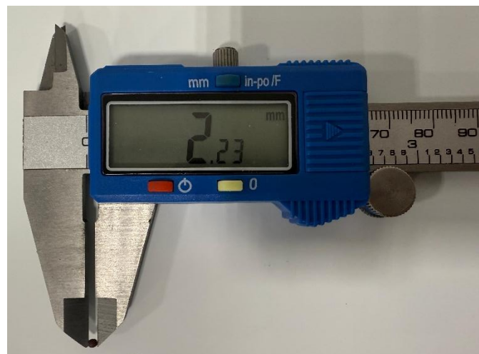
Anexo 8 – Medición tamaño de Canola con un calibrador
