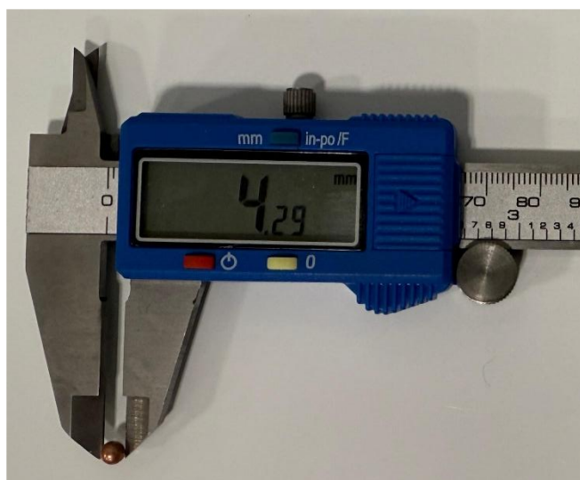
Anexo 9 – Medición tamaño de Balines de cobre con un calibrador
