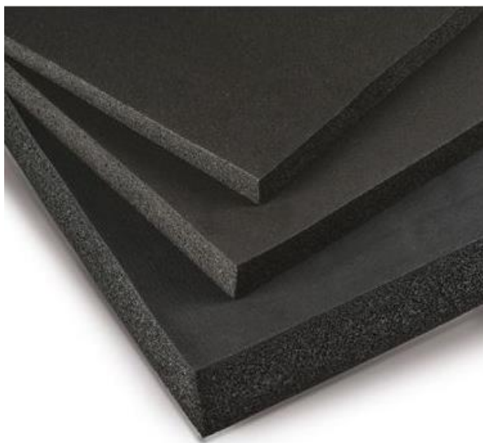
Figura 7. Manta de espuma elastomérica. Tomado de: Safe Energy.
