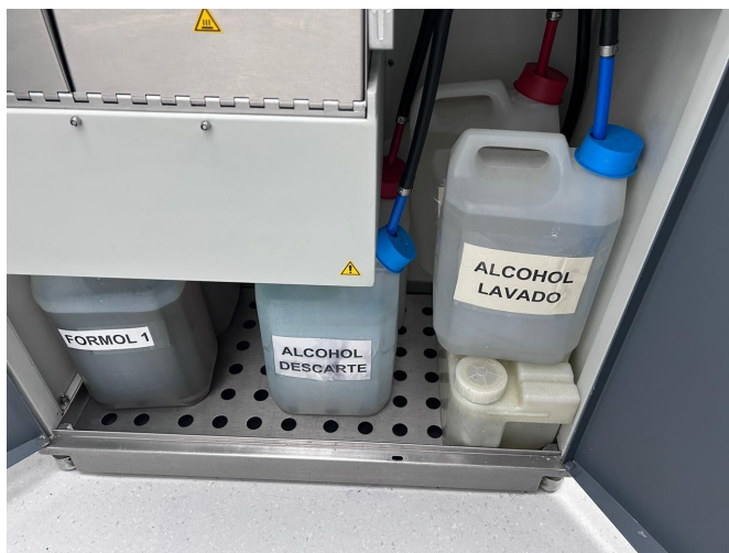
Figura 4. La imagen muestra un compartimiento inferior del procesador de tejidos automatizado en un laboratorio de patología, donde se almacenan reactivos como Formol , Alcohol Descarte, Alcohol Lavado y Xilol en la parte más interna (tapa roja). Cada galón de xileno tiene una capacidad de 6 litros, utilizados principalmente para aclaramiento y lavado de tejidos. Este espacio reducido y cerrado aumenta el riesgo de acumulación de vapores químicos. Imagen del autor.
