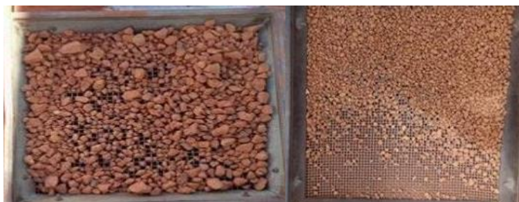
Ilustración 13. Material filtrante para tratamiento de agua residuales Fuente: Análisis del ladrillo triturado como filtro en el tratamiento de aguas residuales provenientes del centro de faenamiento Tena. [43]
