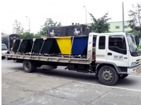
Ilustración 8. Cajas estacionarias para el transporte de los residuos arcillosos. Fuente: Ecoequipos de Colombia
