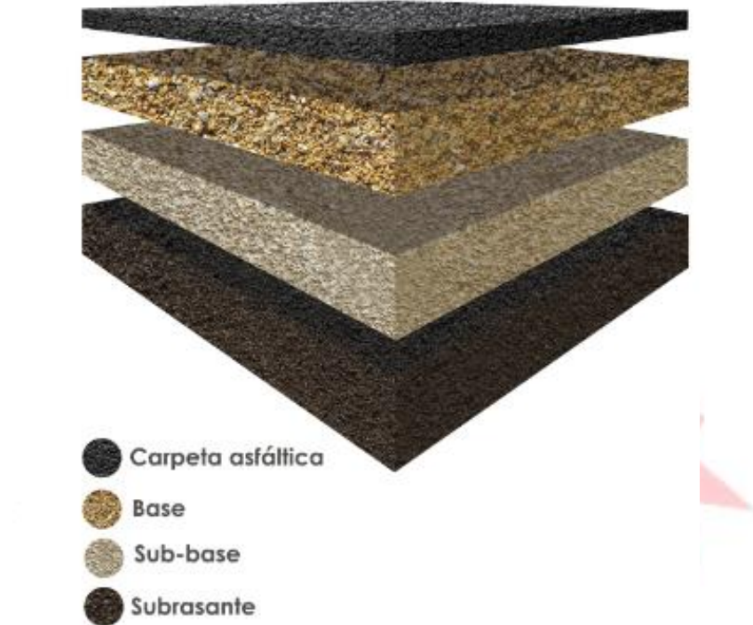
Figura 5.1. Estructura del pavimento asfáltico
