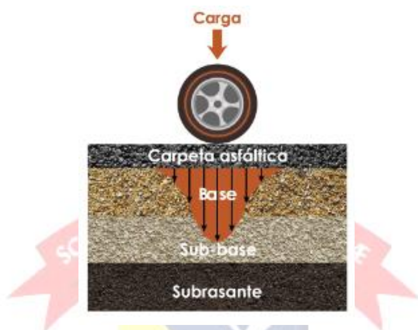
Figura 5.2. Distribución de cargas en el pavimento asfáltico
