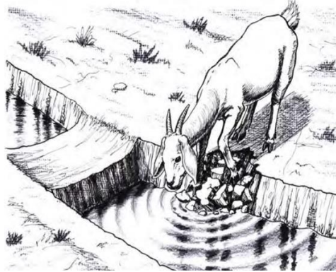
Ilustración 56 Daño en la zanja por animales. Fuente. Cartilla de capacitación JALDA
