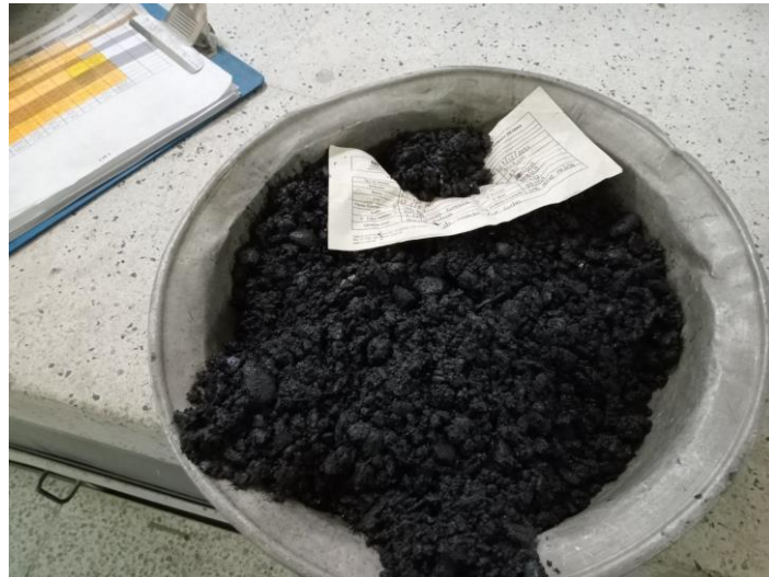
Figura 3. Mezcla asfáltica MGCR TIPO 1.
