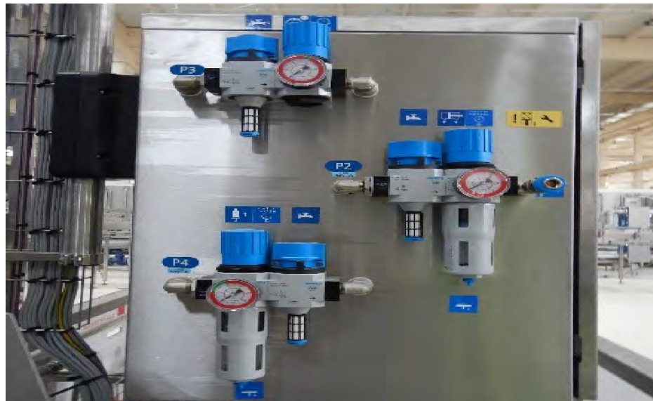
Figura 4. Alimentación de aire circuito neumático de una llenadora de botellas en Central Cervecera.
