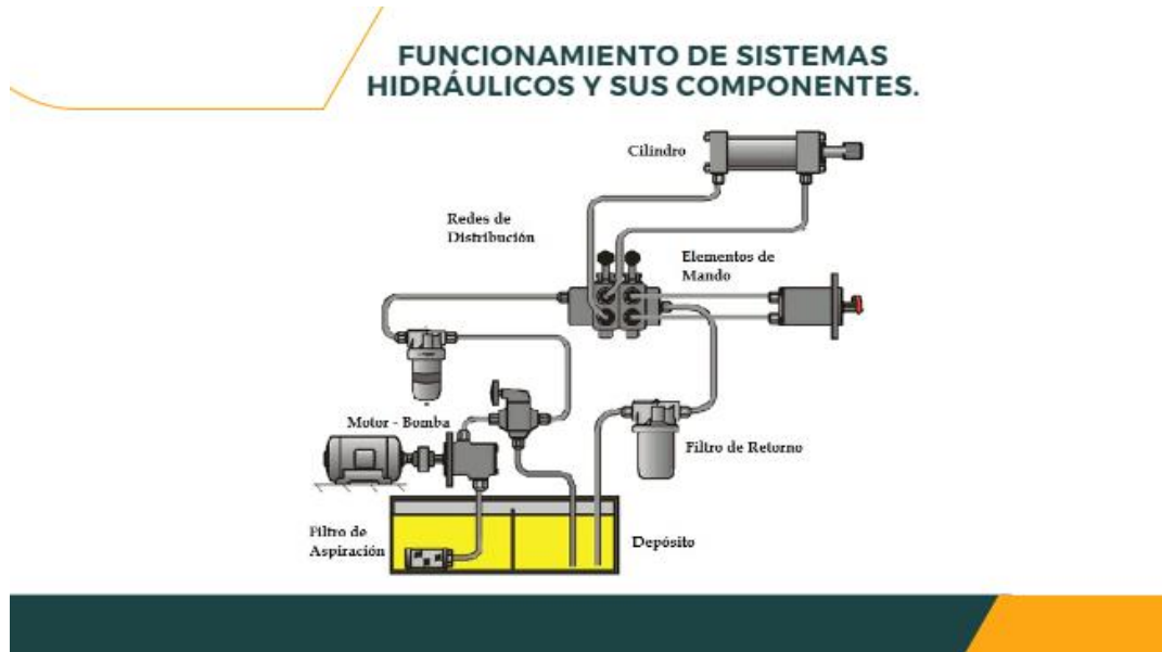
Figura 34. Funcionamiento de sistemas hidráulicos y sus componentes.
