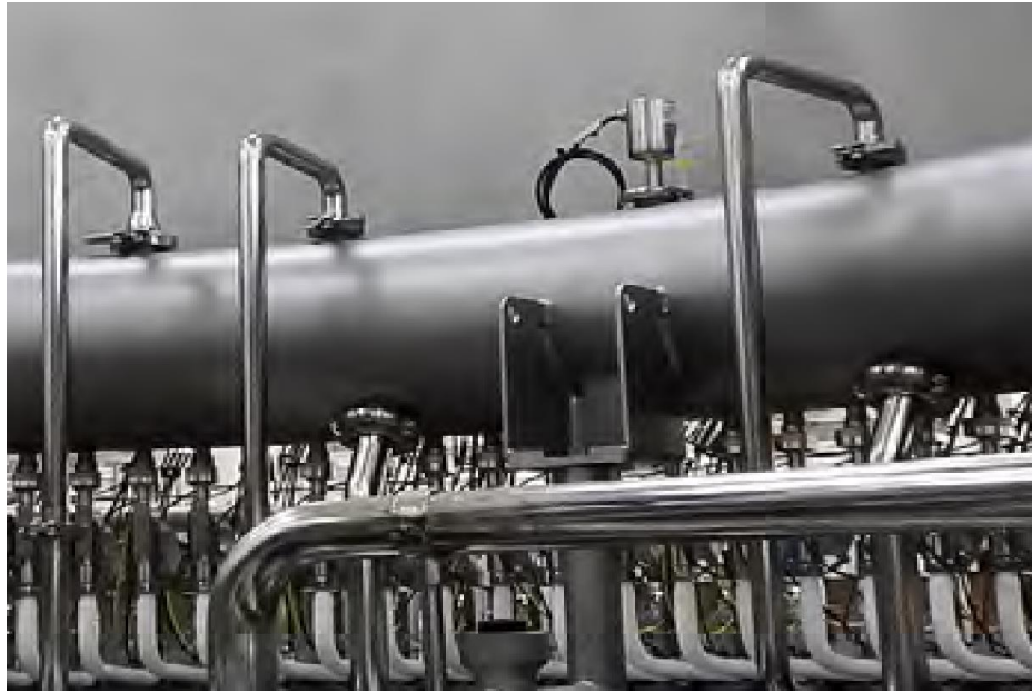
Figura 5. Alimentación de fluidos líquidos depósito de producto de una llenadora de botellas en Central Cervecera.
