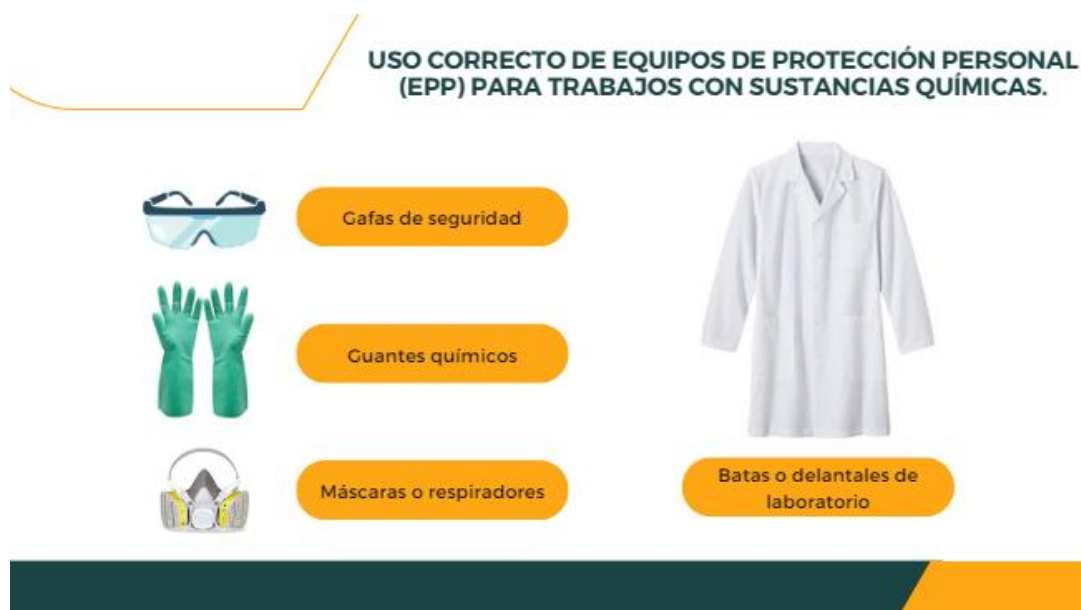
Figura 39. Uso correcto de equipos de protección personal (EPP) para trabajos con sustancias químicas.
