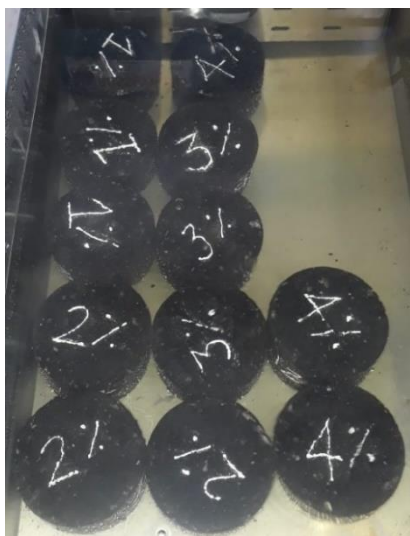
Figura 13. Saturación y estabilización de la temperatura indicada de ensayo Marshall.
