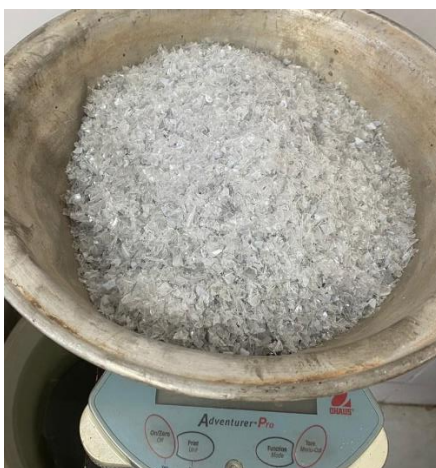
Figura 7. Obtención PET triturado. Fuente elaboración propia.
