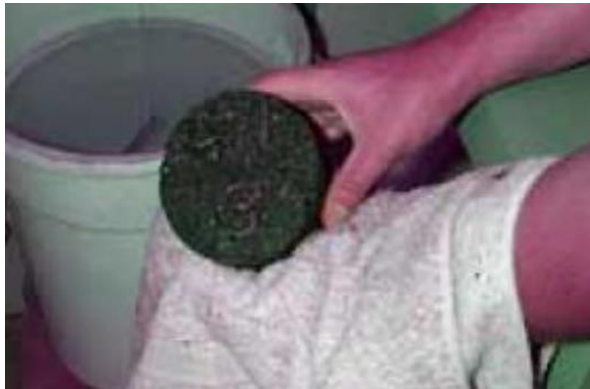
Figura 12. Obtención del estado saturado con superficie seca. Fuente: Norma INV 734.
