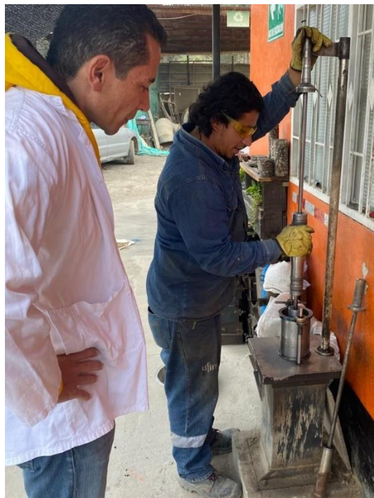
Figura 9. Proceso de compactación con martillo Marshall. Fuente elaboración propia.
