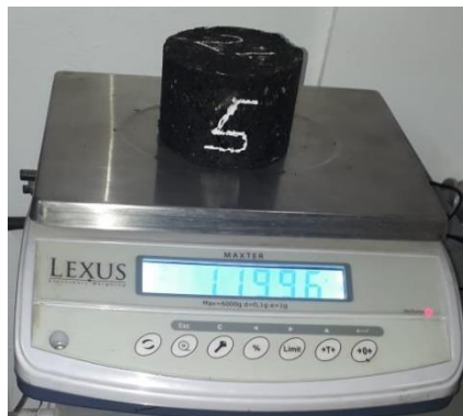
Figura 11. Dispositivo para la determinación de los tres pesos para la determinación del peso específico de la mezcla. Fuente elaboración propia.
