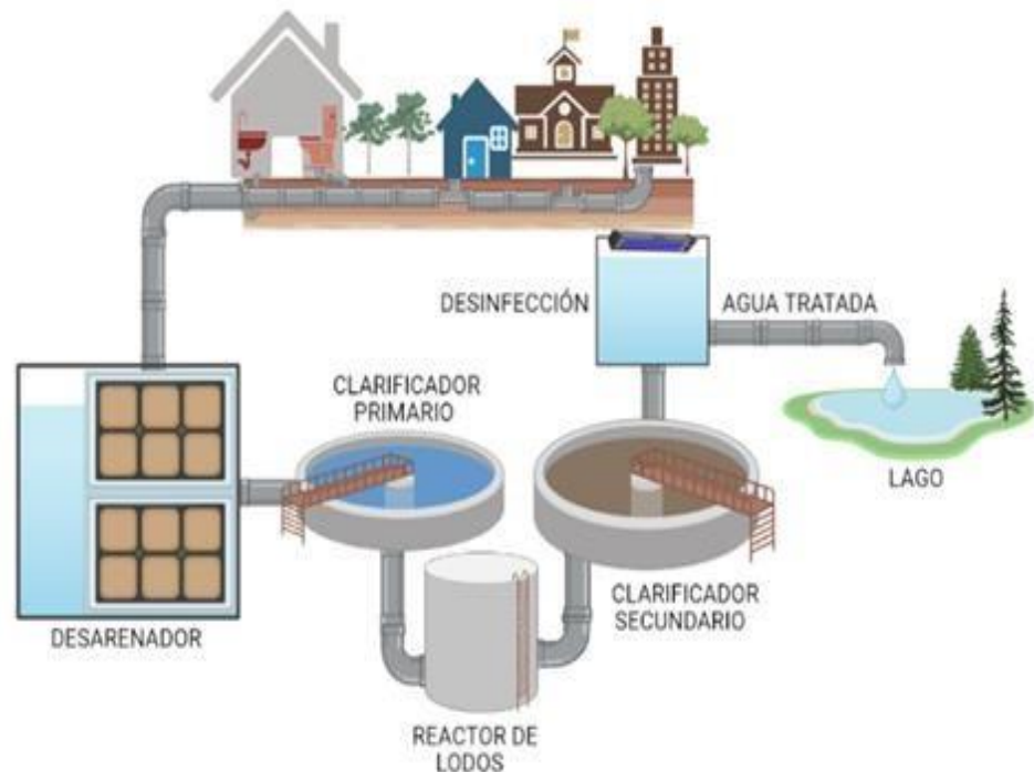
Ilustración 5. Resumen esquema de tratamiento en una PTAR
