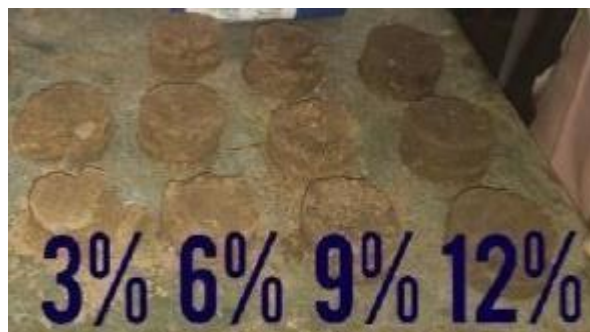
Ilustración 18. Muestras de biosólidos en dosificaciones de 3%, 6%, 9% y 12%
