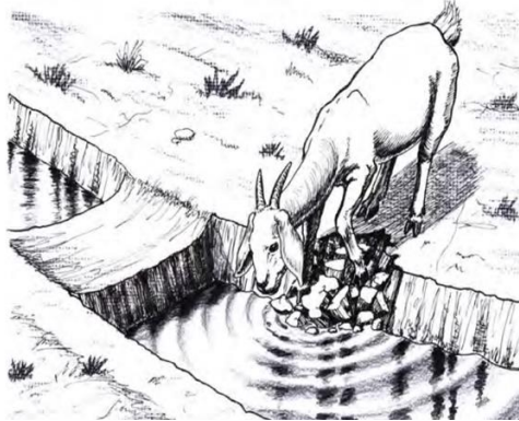
Ilustración 52 Daño en la zanja por animales. Fuente. Cartilla de capacitación JALDA
