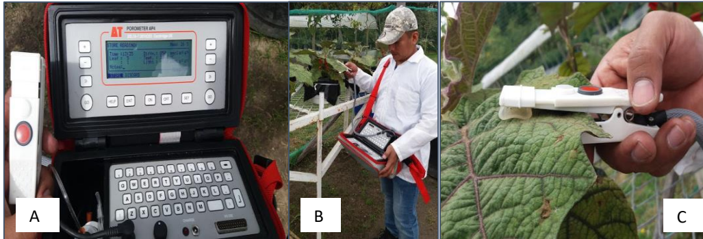
Figura 14. Equipo porómetro (A) empleado para la medición de la conductancia estomática y temperatura de la hoja en plantas de lulo (B), ubicando la cubeta en la parte media e intervenal de una hoja del tercio medio de la planta (C).
