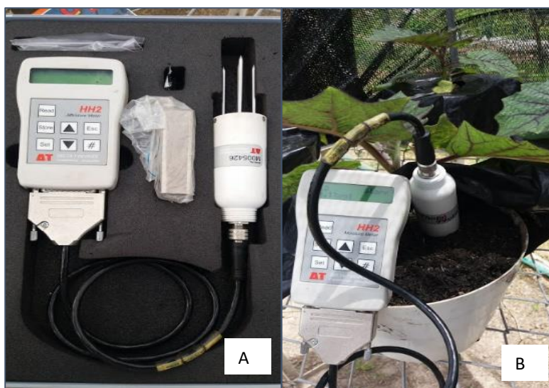
Figura 16. Equipo DELTA-T Devices empleado para medir la humedad volumétrica del sustrato de las plantas de lulo (A); inserción de la sonda en el sustrato (B).
