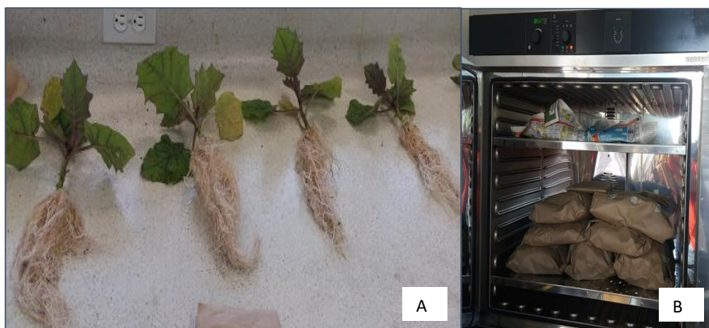
Figura 12. Muestreo destructivo de las plantas de lulo por órganos (tallo principal, raíz y hojas) (A), y ubicación del material vegetal en horno durante cinco días a 50°C para obtención de biomasa (B).
