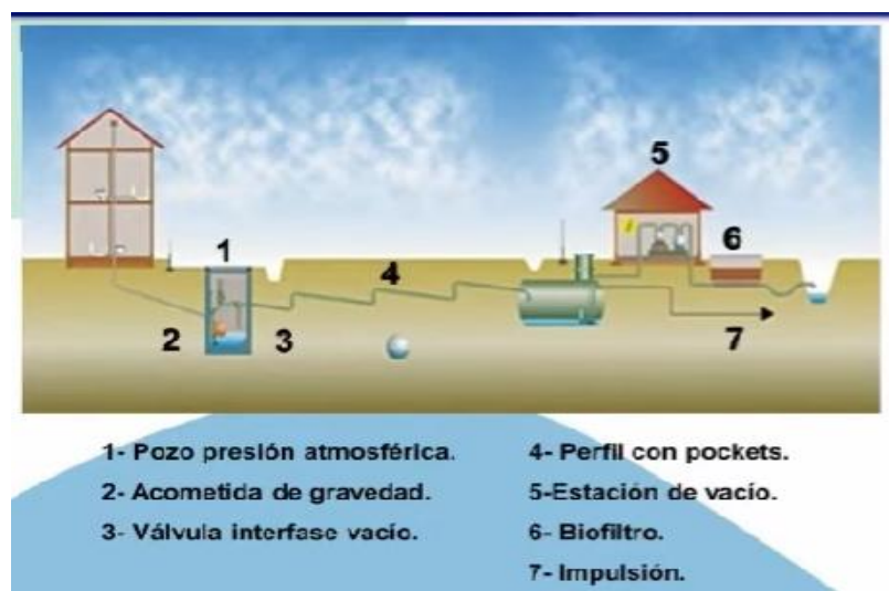
Figura 23. Esquema general sistema de alcantarillado por vacío
